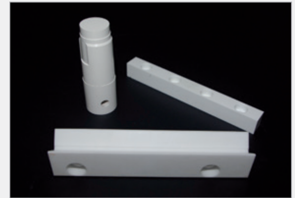
Fräsen von Bauteilen aus ISO-Presskörpern
